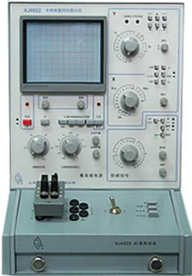
XJ4822 CRT 读出图示仪，外观新颖，技术先进，操作方便，能对各类二极管、三极管、场效应管等静态参数测试。光标测量数字读出给用户带来方便，二簇曲线显示对器件各类参数配对尤为方便。测试大功率器件时，可采用单次方式。配 3KV 测试台后 Vc 可达 3KV。
