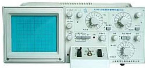
本仪器是用于测量各种半导体管特性曲线和静态参数的测量仪器,是新一代便携式图示仪。整机采用新颖电路设计技术,具备外形轻巧,操作简便,性能稳定可靠,性价比高的特点,能满足大部分半导体器件的测试要求。适合工厂生产线、大专院校教学实验和电子设备维修等领域使用。
