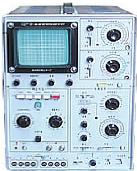
QT2 型半导体管特性图示仪可测量二极管、三极管的低频直流参数，最大集电极电流超过 50A，能满足 500VA 以下器件的测试。本机附有高压测装置，可对 5KV 以下的二极管、三极管进行击穿电压及反向漏电流测试。其测试电流最高灵敏度可达 0.5 $\mu$ A/div
