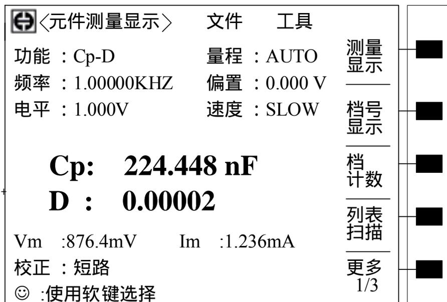
这一显示功能页面显示了测量结果和一些可以设置的状态参数菜单，包括功能参数(L, C, R, Z...), 量程, 频率, 偏置, 电平, 速度等等, 还在监视区域显示了当前被测元件上的压降(Vm:)和电流(Im:) (如果用户开电压电流监视的话)和用户校正的选项。
