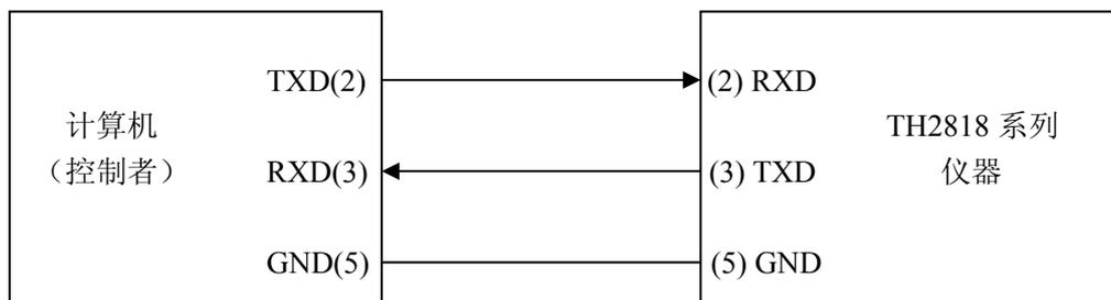
由上图可以看到，TH2818 系列仪器的引脚定义与 IMB AT 兼容机使用的 9 芯连接器串行接口引脚定义有所不同。用户可以从同惠电子有限公司购买到计算机与 TH2818 系列仪器的串行接口电缆线。
