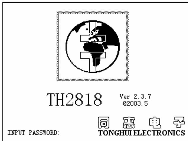
如果用户开启了密码保护功能，则仪器会要求开机密码，根据屏幕提示，输入开机口令，按键[ENTER]进入主菜单画面。
