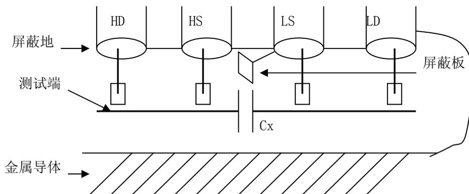
图 2 消除杂散电容影响方法示意图
