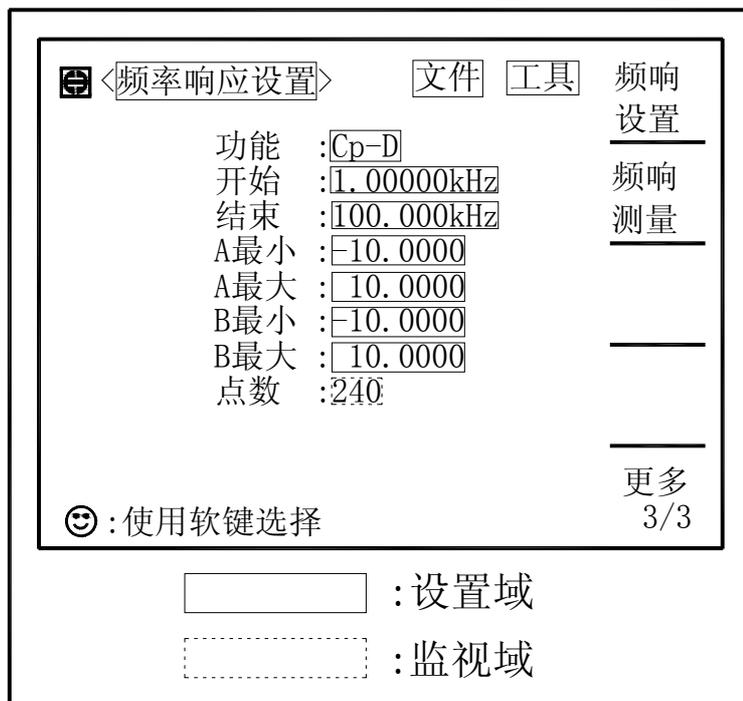
这一显示功能页面用于完成对频率响应曲线扫描测量参数的设定，包括功能参数，扫描起始截止频率，主副参数纵坐标的上下限。
