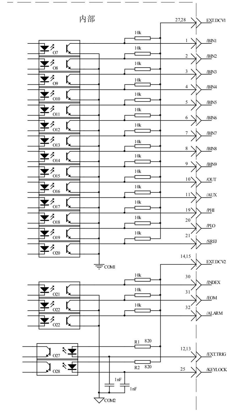
注意：本仪器 HANDLER 接口卡在设计上为方便和统一起见，内部电压统一采用+5V，因此本说明书所述内部电源电压实际使用值为+5V，不可调。而当要使用内部电源时，必须使仪器上的 Handler 接口板的跳线短接。
