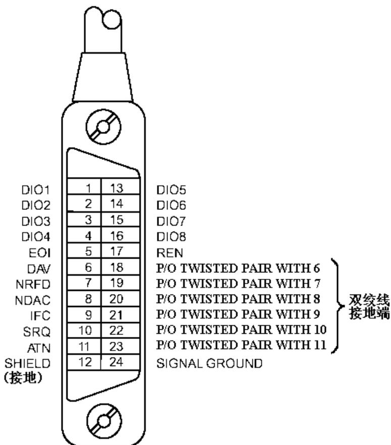
图 1 GPIB 接插件/管脚结构图
