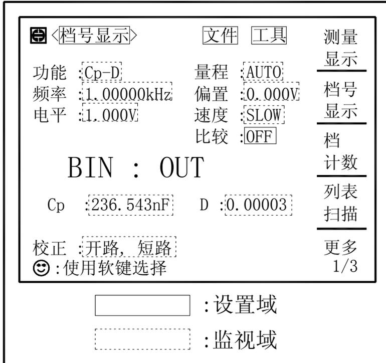
下列测量控制参数可在<档号显示>页面设定。
