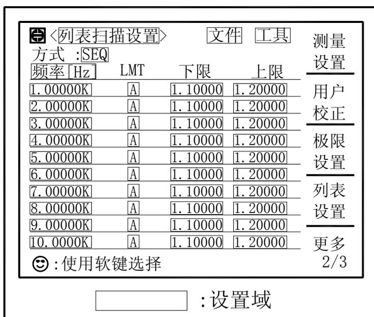
TH2818 的列表扫描功能可对最多 10 个点的测试频率，测试电平或偏置电压进行自动扫描测试。在<列表扫描设置>页面可对下列列表扫描参数参数进行设定。
