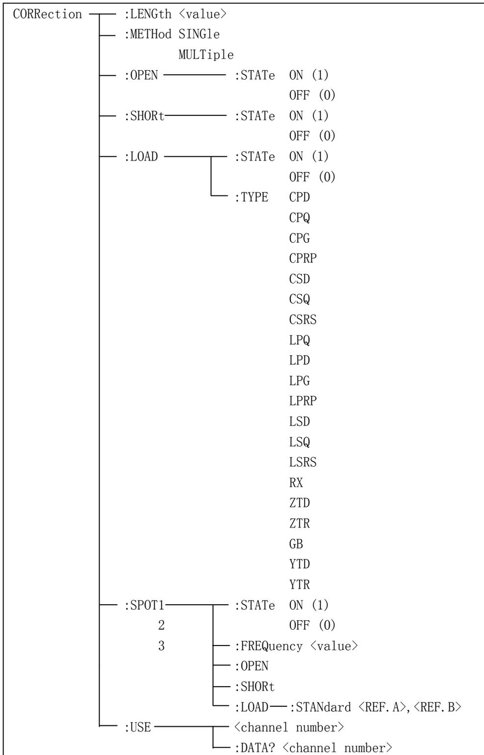
:LENGth 用于设定仪器的校正电缆长度, 字符? 可以查询当前设定电缆长度。
