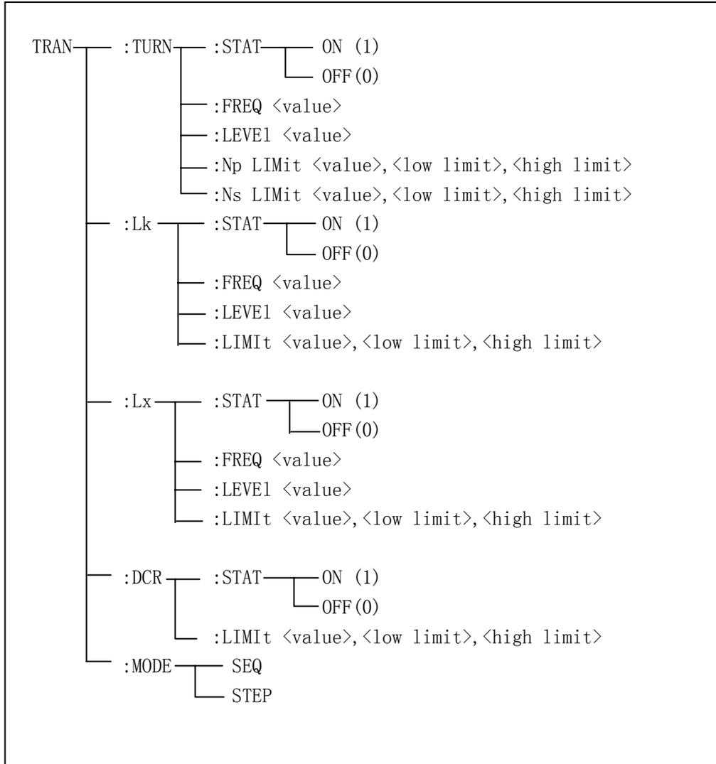
:TURN: STAT 用于设定变压器匝比测试参数开关状态。可以查询当前仪器设定匝比开关情况。
