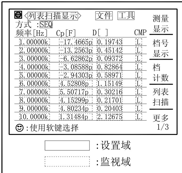
在该显示页面测试点将被自动扫描测试，测试结果与极限值进行比较。在列表扫描测试过程中，最左面的符号“▶”指示当前扫描测试点。下列测量控制参数可在<列表扫描显示>页面设定。
