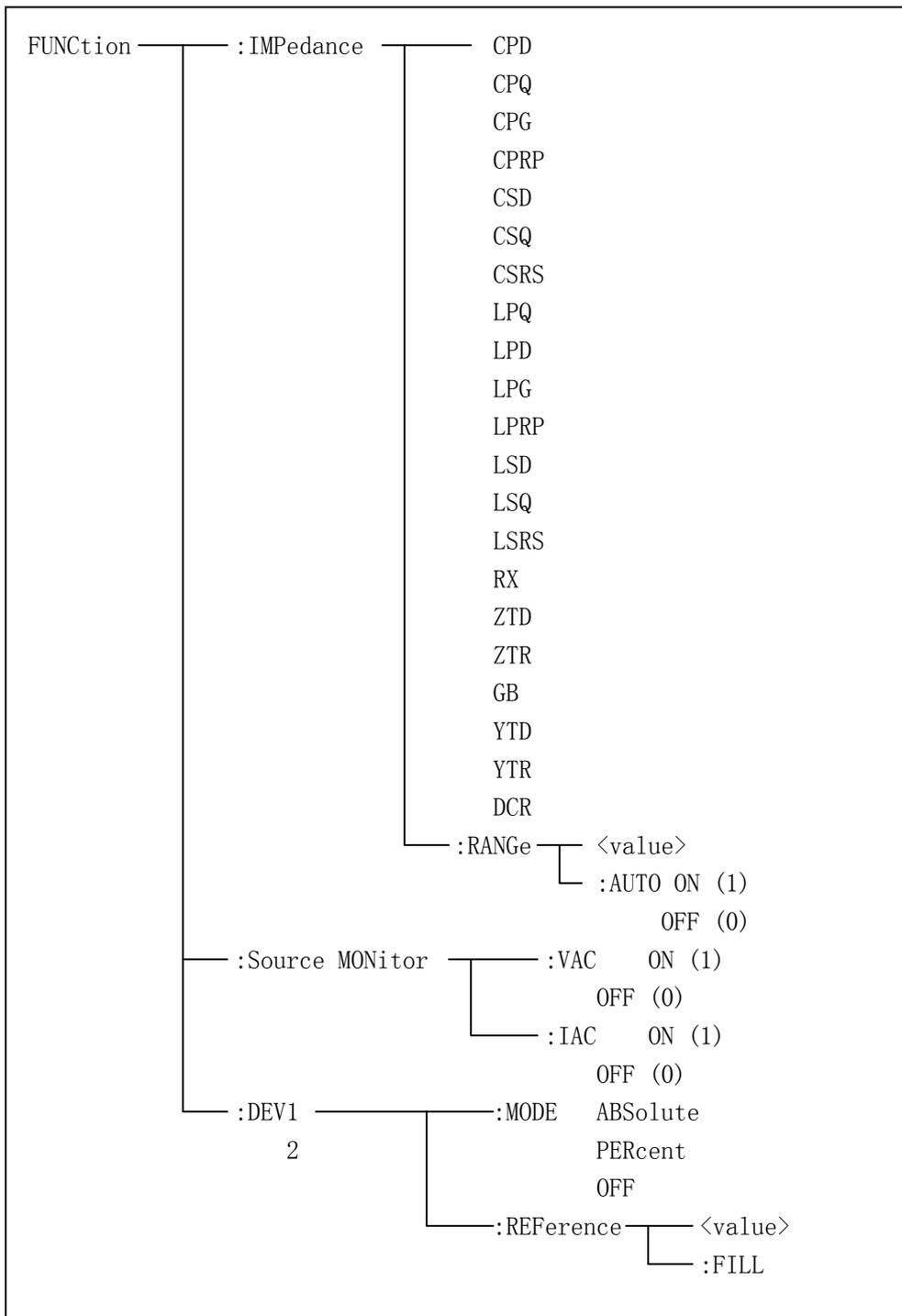
:IMPedance 用于设定仪器的“功能”参数，字符? 可以查询当前的“功能”参数。
