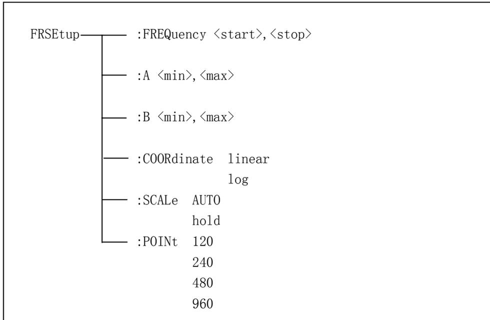
:FREQuency 用于设定频响测试扫频起始频率, 结束频率。可以查询当前仪器设定起始和结束频率。
