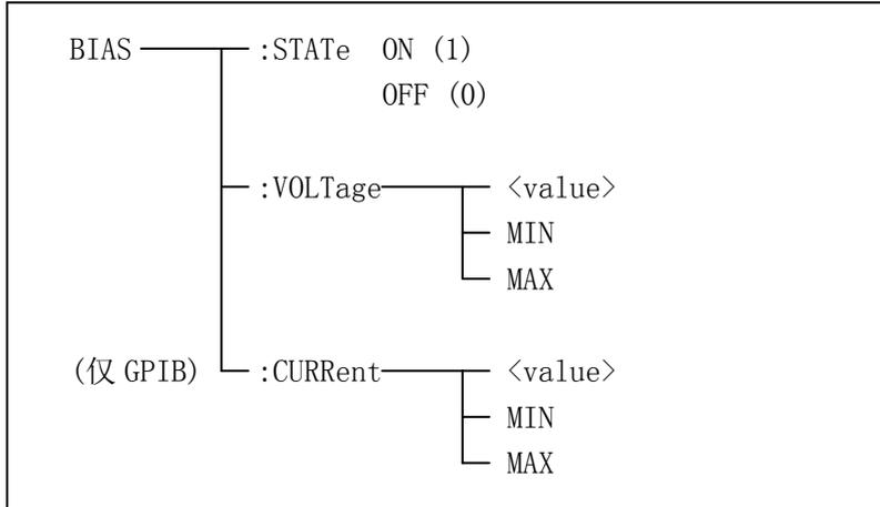
:STATe 用于设定仪器的偏置开关, 字符? 可以查询当前的偏置开关。
