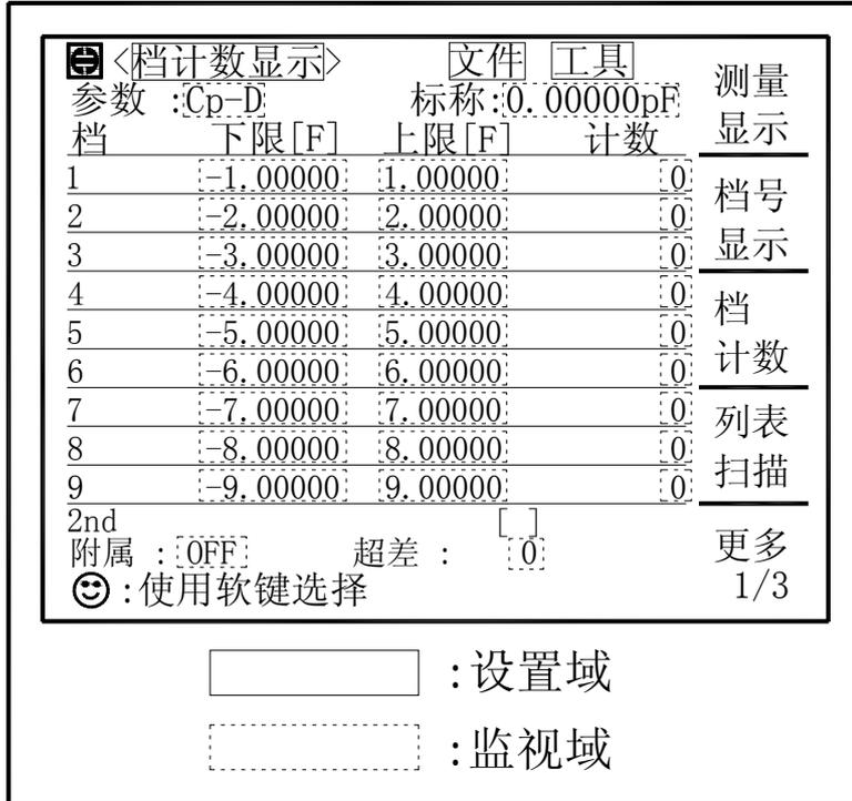
下列测量控制参数可在<档计数显示>页面设定。
