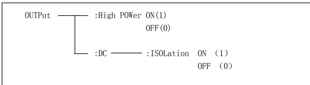
:HPOWER 用于设定仪器的 DC 100mA/10V 偏置源打开或关闭, 字符? 可以查询当前的偏置
