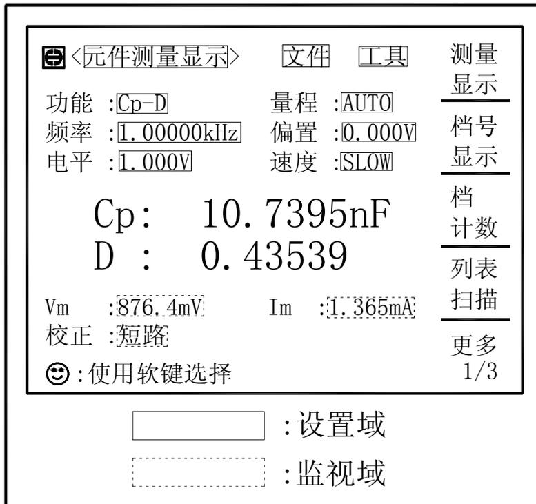
在该页面上，测试结果将以大字符显示。下列测量控制参数可在本页面设定。
