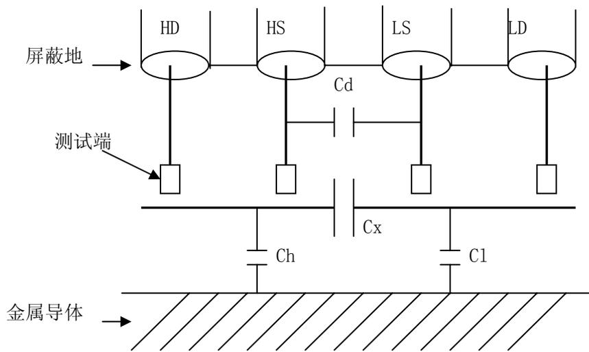
图 1 杂散电容的影响示意图
