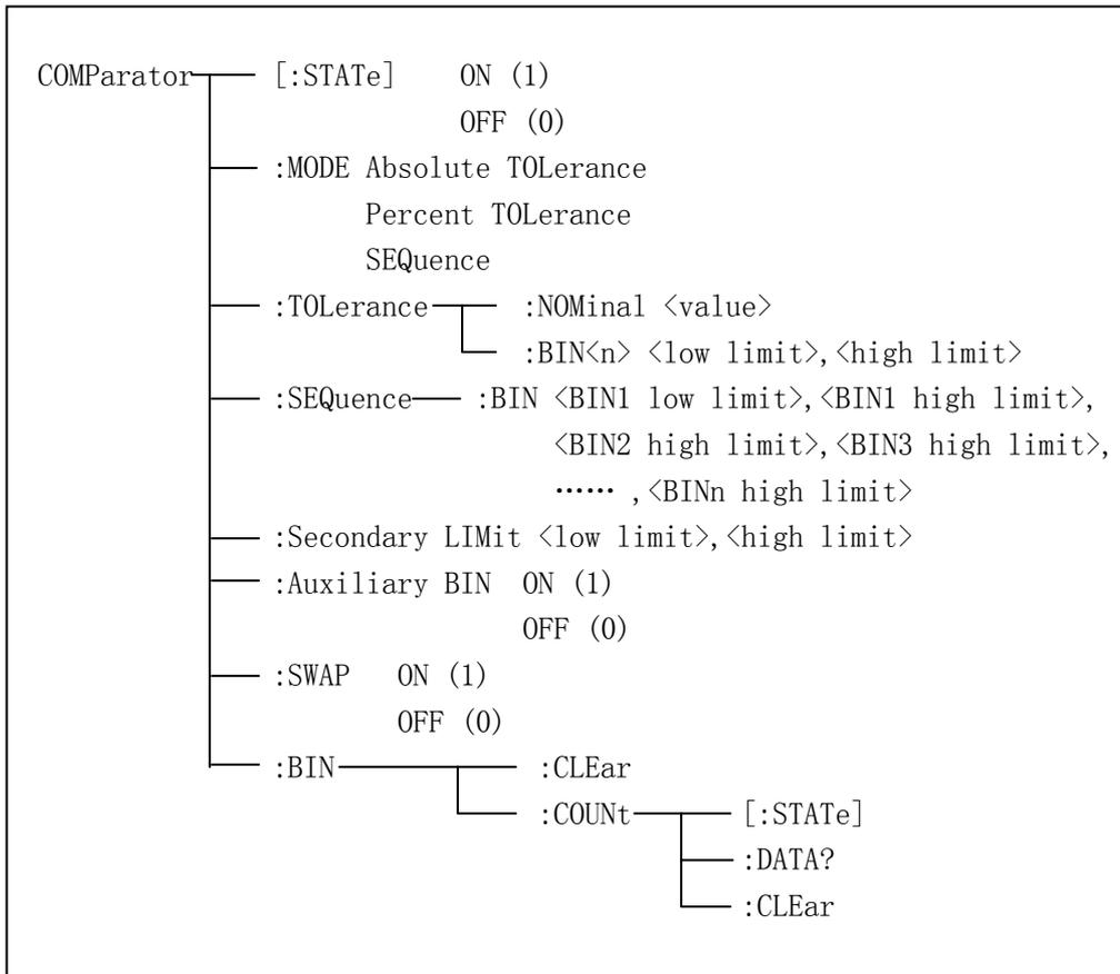
[:STATe]用于设定仪器比较功能开启或关闭。可以查询当前比较功能状态。
