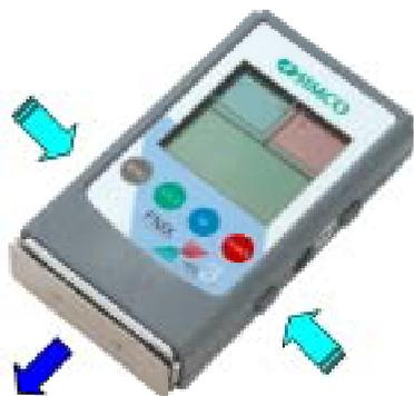
取り外したイオンバランス測定用プレートを検知部側に移動させ、フロントサイドプレート挿入口（フロント部分の長方形の穴）に差し込んで下さい。イオンバランス測定用プレートに上下の向きはありません。
