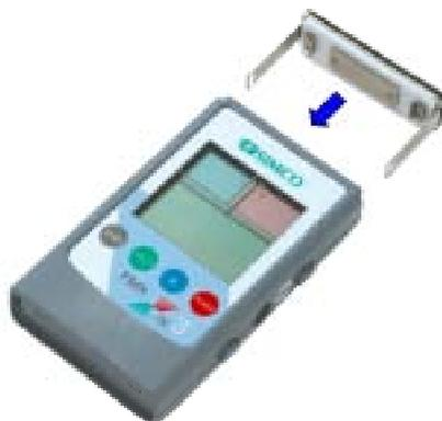
正しく挿入できた場合は右の写真のように、イオンバランス測定用プレートとFMX-003の前面部が、がたつきの無い、均等な平行になります。
