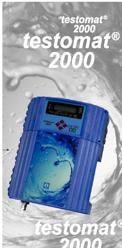
Testomat 2000 在线测量仪器可测定水样中的残余硬度、总硬度、碳酸钙硬度、p-value 以及 minus m-value (pH 4.3 时的酸度)。这些参数对于纯净水、饮料和饮用水等生产中的水质监测是至关重要的。测量通过 LCD 显示、具有两组控制点进行输出控制。采用精密的活塞定量泵进行试剂滴定，每滴为 30 微升，滴定非常精确，从而保证测量更加准确。每一个测量周期大约需要 3-5 滴试剂，非常节省试剂，运行费用非常地低。另外，还可以进行双通道测量，对两个不同采样点的水样测试监控，更加经济实惠。依实际需求，可以选择不同的测量周期如设置间隔时间、水量控制或外部讯号控制达到最合理的测量方式，达到监测和控制功能。
