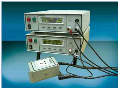
7305可與Extech 7122連結組成 安規四合一測試系統(ACW,DCW,IR,GB)
