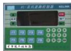
装车控制器（面板安装型）
