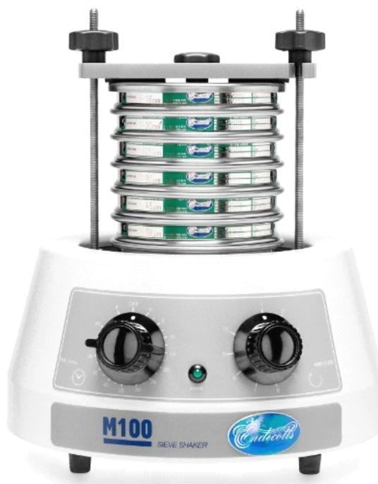
M100 筛分仪是一款价廉物美的针对直径 100mm 和 3 英寸筛网设计的小型实验室筛分仪。稳固耐用，轻量便携，操作者能完全控制振幅和振动时间。
