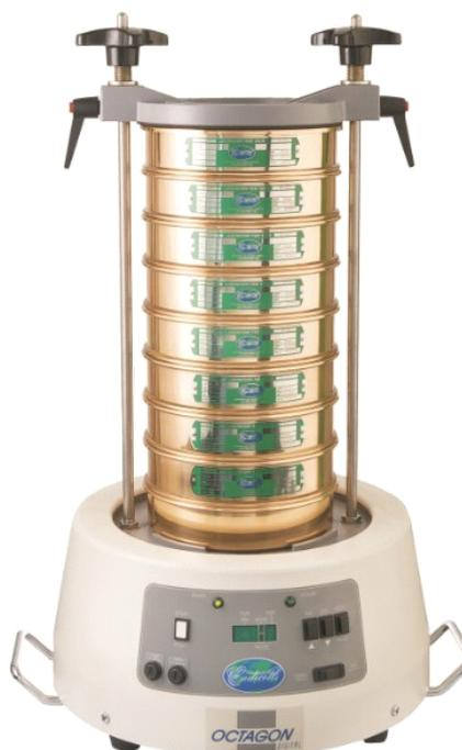
OCTAGON D200 高效数显筛分仪的数显控制器可以设置操作时间、振幅，亦可设置连续震动或间歇震动，间歇震动。间歇震动可以清除阻塞物增进分离效果。控制器还能设置振动“开”和“关”的持续时间。
