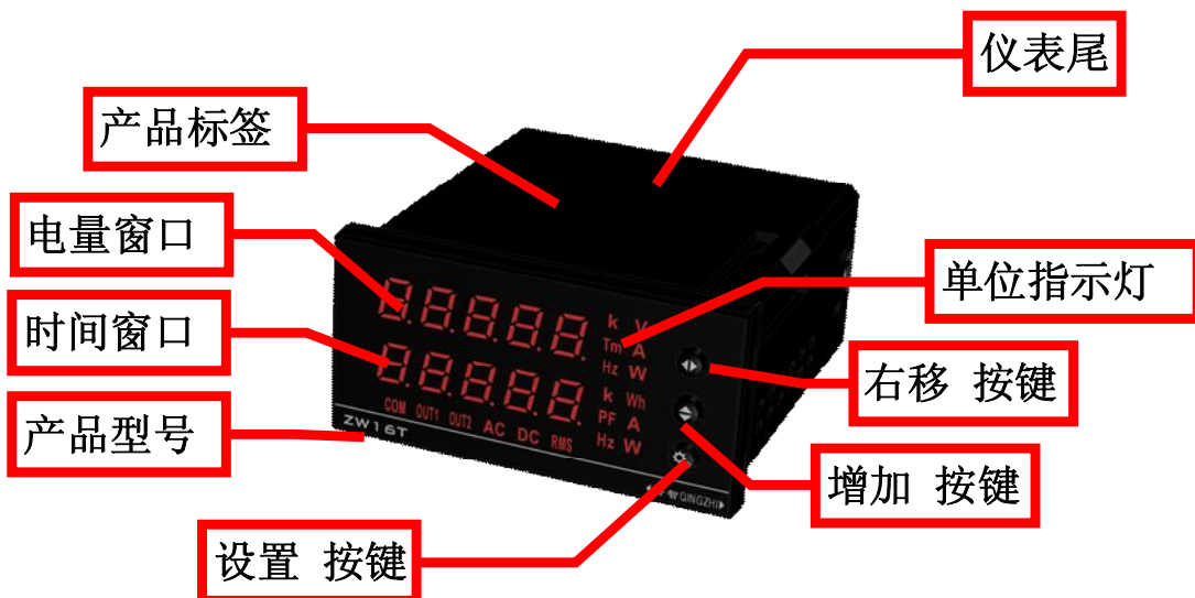
图 2 ZW1622A/W 仪表实物图示
