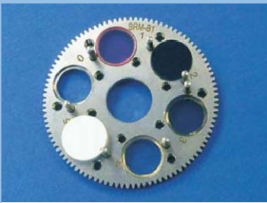
内部标准验证单元确保测试结果的正确性。
