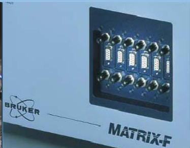
光谱主机可同时连接6个发射探头或常规探头，大大减少了投入费用。
