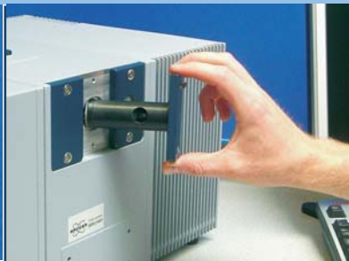
激光管和光源采用预准直设计，维护简便易行。
