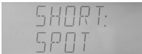
图 4—4 短路点频清零功能
