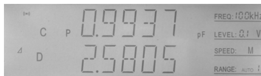
图 4—6 绝对偏差显示方式
