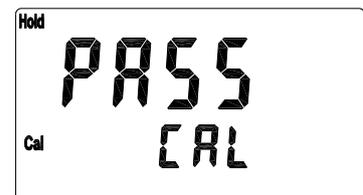
8. 螢幕顯示 CAL PASS 後，然後自動顯示校正之 oS (零點電位) 值，顯示校正之 SLP (斜率) 值，自動回到測量模式。
