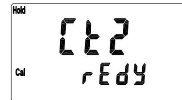
5. 將電極清洗乾淨後放入第二點標準液內，按
