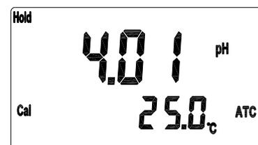
3. 此時螢幕顯示 CA2 第二點校正，按
