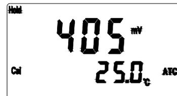
6. 測值停止閃爍後，顯示第二點校正之 pH 值。
