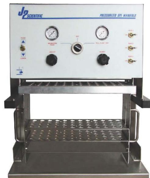
J2 scientific 公司最新推出了一个简单有效的正压装置，其具有高效、简便的特点。它可通过该装置中的气流调节阀来控制小柱流速的大小，并可直接吹干小柱，保证每个小柱在活化洗脱过程中具有良好的重现性。
