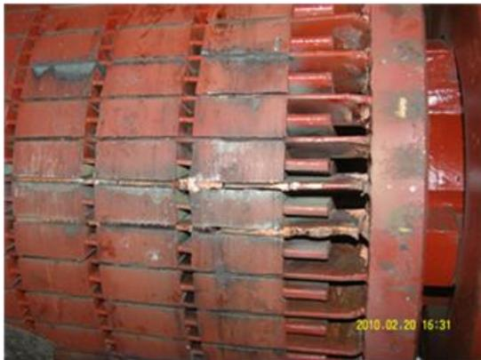
利用 ESA 技术检测出电动机转子严重断条，质量不平衡和定子偏心故障并得到验证。事后用户总结“.....如果没有这次电动机状态检测，我公司的这两台高压电机只是通过常规的巡检就不可能发现设备存在的安全隐患，任其发展后果不堪设想 ..... 我公司的两台高压电机的检测结果与电机的实际故障非常吻合，为排除设备的故障提供了可靠的事实依据.....”
