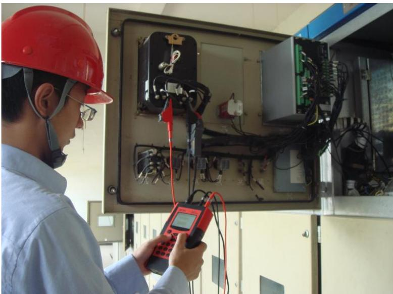
使用者首先用 DMT301 电动机故障检测仪在 MCC 检测和采集电动机的电流和/或电压信号，然后通过 USB 接口将数据上传到 PC 机。EMA 诊断软件进行数据存储，频谱处理和特征分析，得到自动诊断结论和维修建议，并可以用软件提供的报表和图谱工具查看和验证各种故障的特征。
