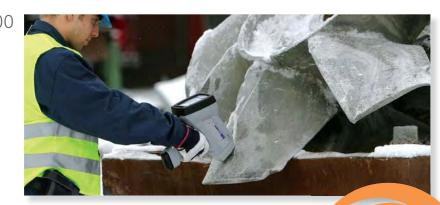
这种高效的便携式检测工具 - 对金属回收、塑料回收、电子制品及木材回收而言必不可少 - 率先实现在无需真空泵或氦气罐附属装置的条件下,即可对 6061/6063 合金进行分拣。
