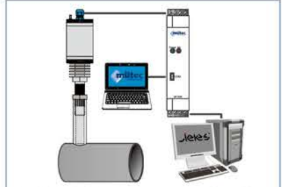
系统构件：整个测量系统MF3000包括传感器、电缆、DIN-轨式变送器和软件MF-SMART
