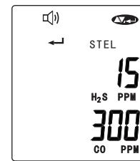
这是STEL报警设定值的页面。屏幕上将显示[喇叭][←][STEL]和[●]的图标，以及两种气体的STEL报警设定点。如果不需任何改变按[▲]键前进至下一屏，如果需要改变数值，按[←]键，此时屏幕上第一个STEL报警设定值将闪动，按[▼]和[▲]键调整数值，设置完毕后按[←]键选择设置下一个STEL报警值。重复该步骤直至完成两个STEL报警设定值的设置，当设置全部完成后，屏幕上会一直出现[喇叭][←][STEL]和[●]图标，以及两种气体的STEL报警设定点，此时，若按[←]键将返回该模式，您可以重新设置STEL报警设定值；若按[▲]键，您就可以进入到安全密码设置页面。在数值闪动时若按一次[↓]键，即可返回到最初的STEL报警设置页面，但所设置变更将不被保存，再按一次[↓]键，仪器返回常规气体读数模式页面。
