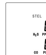
在气体读数模式下，按[▲]键4次，仪器进入STEL读数观察模式，在该模式下屏幕上出现[STEL]字符以及两个有毒气体传感器测得的STEL数值这两个有毒气体传感器的STEL（短期暴露极限）在每次仪器断开电源后将重新设置，而STEL时间基准设定为15分钟。STEL只对有毒气体传感器有效。若仪器为无毒气体传感器，该项将不显示。
