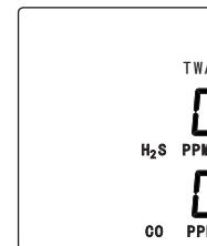
在气体读数模式下，按[▲]键3次，仪器进入TWA读数观察模式，在该模式下，屏幕上出现[TWA]字符以及两个有毒气体传感器测得的TWA（时间平均暴露量极限）数值。TWA值在每次仪器断开电源后将重新设置，而该时间基准设定为8小时。TWA只对有毒气体有效，若仪器为无毒气体传感器，该项将不显示。
