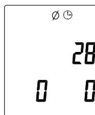
在气体读数模式下按1次[▲]键，仪器进入校准模式，在此模式下，屏幕上仅显示图标[Ø]和[←]，在校准模式下，按[←]键即开始调零，此时，屏幕显示[Ø]和[⊕]图标以及硫化氢传感器的标定值(Span)其他传感器显示0。完成此步骤后，仪器自动回到气体读数模式，若仪器未设置密码保护，屏幕上显示[⊕]图标。此时按[←]键，可使仪器开始对其余的传感器进行校准。更多说明请参阅仪器校准模式章节。
