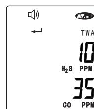
这是TWA报警设置页面。屏幕显示[◁][←][TWA]和[◀]的图标，以及两种气体的TWA报警设定点。如果不需任何改变，按[▲]键前进至下一屏。如果需要改变数值，按[←]键，此时屏幕上第一个TWA报警设定值将闪动，按[▼]和[▲]键调整数值，设置完成后按[←]键选择设置下一个TWA报警值。重复该步骤直至完成两个TWA报警设定点的设置。当2个TWA设置全部完成后，屏幕上会一直出现[◁][←][TWA]和[◀]图标，以及两种气体的
