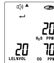
这是高浓度设置页面。该屏幕显示[◁][▲][◀]和[←]字样的图标，以及三种气体浓度的高浓度报警设定点。如果不需任何改变，按[▲]键前进至下一屏。如果需要改变数值，按[←]键，此时屏幕上第一个高报警值将闪动按[▼]和[▲]键调整数值，设置完毕后按[←]键确认并选择设置下一个高浓度报警值。重复该步骤直至完成所有三个高浓度报警设定点的设置，当三个值全部设置完成后屏幕上会一直出现[◁][▲][◀]和[←]的图标，以及三种气体的高浓度报警设定点。此时，若按[←]键，您可以再次设置高浓度报警设定点；若按[▲]键，您就可以继续进入到TWA的报警设置页面。在数值闪动时即设置报警参数时，按一次[⌚]键，即可返回到最初的高浓度报警设置页面，但之前所设置变更将不被保存，再按一次[⌚]键，仪器返回常规气体读数模式页面。高浓度报警器是非锁定报警器。
