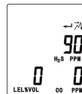
在气体读数模式下，按2次[▲]键即可前进至峰值显示模式。在此模式下，屏幕将显示有毒气体和可燃气体传感器所测得的峰值气体浓度读数，硫化氢传感器测得的最低气体浓度值以及[↗]和[←]图标，按[←]键复位所有的峰值为当前的读数。
