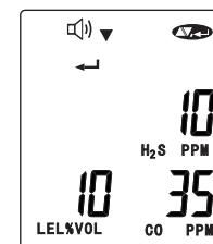
这是低浓度设置页面。该屏幕显示[◁][▼][◀]和[←]字样的图标，以及三种气体浓度的低浓度报警设定点。如果不需任何改变，按[▲]键前进至下一屏。如果需要改变数值，按[←]键，此时屏幕上第一个低报警值将闪动按[▼]和[▲]键调整数值，设置完毕后按[←]键确认并选择设置下一个低浓度报警值。重复该步骤直至完成所有三个低浓度报警设定点的设置，当三个值全部设置完成后屏幕上会一直出现[◁][▼][◀]和[←]的图标，以及三种气体的低浓度报警设定点。
