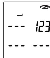
左图所显示的是安全密码设置页面，图中所显示的123数字是仪器原先设定的密码。如果不需要任何改变，按[▲]键前进至LEL标准气模式。如果需要更改密码，按[←]键，此时安全密码的第一个数值会闪烁，按[▼]和[▲]键更改第一位数字，更改完成后按[←]键确认，确认后跳到下一位数值，用同样的方法更改后两位数字。设置完成后屏幕上会以新密码显示，此时若按[←]键将返回安全密码设置模式，您可以重新设置密码；在数值闪动时若按一次[⊕]键，即可返回到最初的安全密码设置页面，但所设置变更将不被保存。再按一次[⊕]键，仪器返回常规气体读数模式页面。若已设置安全密码，如果没有输入正确的安全密码，则用户就不能校准或对仪器设置做任何改动。如需校准仪器，用户首先需重新启动仪器，并进入设置模式，输入正确的安全密码。一旦正确的密码被输入，用户就能各项设置，或对仪器进行校准。
