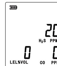
开机后进入气体读数模式，将开始对全部三种气体（LEL,CO,H<sub>2</sub>S）或其中的几种进行连续不间断的检测，并且实时更新液晶显示屏上的检测数据。在屏幕的左上角还有一个电池电量指示图标，用以提醒用户电池电量状况。当电池电量减少时，图标的阴影部分也会随之减少。如果上述任何一种气体的浓度超过了低浓度或高浓度报警设定值（包括STEL/TWA报警设定值），仪器就会发出报警。在报警状态下，仪器按一定频率就会发出低频蜂鸣（低浓度报警），高频蜂鸣（高浓度报警），光报警以及振动报警。当气体浓度低于报警设定值时，仪器将返回到气体读数模式。在气体读数模式下，还可以通过按[▲]键进入另外3个模式。
