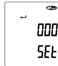
在读数模式下同时按住[▼][▲]键，仪器将进入设置模式。在此模式下，用户不仅可以改变低浓度、高浓度、TWA、STEL的报警设定值，还可以对安全密码进行设定（出厂密码为123）。如果您已设置了密码，按[▼]和[▲]键改变屏幕上显示的数值，输入正确的密码后仪器将直接进入低浓度报警设定点的设置页面。在输入密码时，确定第一位的数值后，按[←]键就可继续选择输入下一位数值了。重复该步骤，正确输入三位数的密码后，按[←]键确认。在改设置模式下，有任何设置发生变化，仪器必须先关机，再重新开机。
