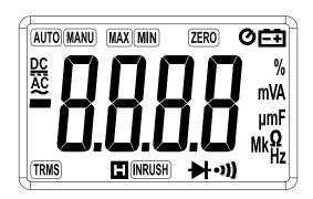
MIN 最小值测量状态 ZERO DCA 自动回零 0 自动关机状态 盡 电池不足 TRMS 真有效值 н 读数保持状态 INRUSH 浪涌电流测量状态 % 百分比(占空比) mV, V 毫伏特, 伏特(电压)
