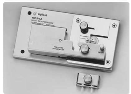
16194A 高温元件测试夹具 频率: dc ~ 2 GHz 最大直流偏置: \pm 40 V 工作温度: -55 ^{\circ} C ~ +200 ^{\circ} C
