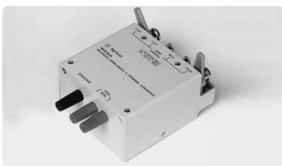
16314A 平衡 / 非平衡 4 端子转换器 频率: 100 Hz ~ 10 MHz 接口: 4BNC (非平衡), 2 信号端子 (平衡) & 接地端 特征阻抗: 50 \Omega
