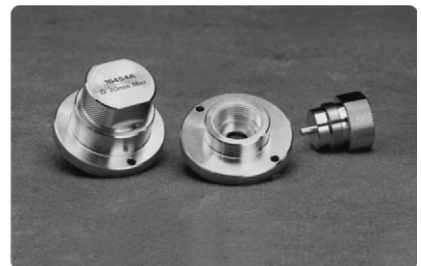
16454A 磁体测试夹具 频率: 1 MHz ~ 1 GHz 样品尺寸: (只计算环形部分) 高: \leq 8.5 mm 内径: \geq 3.1 mm 外径: \geq 20 mm
