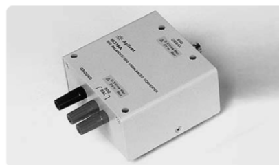
16315A' 50 \Omega 平衡 / 50 \Omega 非平衡转换器 频率: 100 Hz ~ 10 MHz 16316A' 100 \Omega 平衡 / 50 \Omega 非平衡转换器 频率: 100 Hz ~ 10 MHz 16317A' 600 \Omega 平衡 / 50 \Omega 非平衡转换器 频率: 100 Hz ~ 3 MHz
