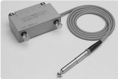
4291A 阻抗探测工具 频率: 40 Hz ~ 100 MHz 最大直流偏置: \pm 40 V 探测电缆长度: 1.5 m 只与 4294A 配合使用
