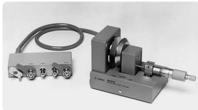
16451B 电介质测试夹具 可测量参数: 电容 (C), 耗散系数 (D), 和介电常数 ( \epsilon_r' , \epsilon_r'' ) 被测材料尺寸 厚度: \leq 10 mm 直径: 10 ~ 56 mm 频率: \leq 30 MHz
