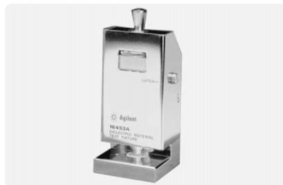
16453B 电介质测试夹具 频率: 1 MHz ~ 1 GHz 样本尺寸 (只计算平面部分): 厚度: 0.3 mm ~ 3 mm 直径: \geq 15 mm
