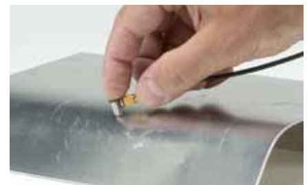
可测量金属材料因弯曲而变薄的临界厚度值。
