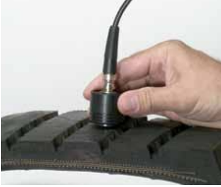
测量橡胶传送带或轮胎中钢帘线的深度。
