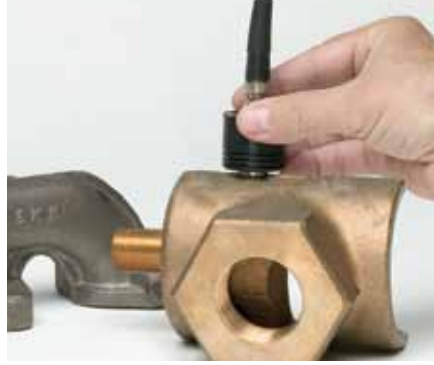
35HP测厚仪可以测量汽缸内腔和许多其它金属铸件以及具有声速衰减性的材料。
