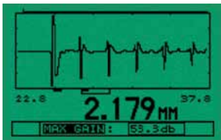
操作人员可以在可选A扫描模式下查看厚度和波形
