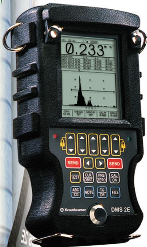
右上图：有涂层厚度和零件壁厚显示的 A 扫描 右下图：Krautkramer 的 TopCOAT 技术：
