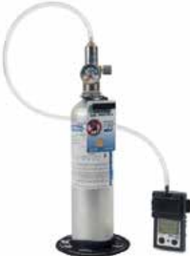
扩散型监测仪和主动式恒流阀。
