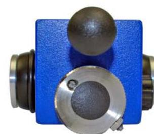
Die Bleistiftspitze ragt nun ca. 10 mm unter dem Block heraus. Den **TriForcePencil** vorsichtig auf den Prüfling setzen, wobei das Gerät zuerst mit den Rädern aufzusetzen ist und erst danach mit der Bleistiftspitze. Das Gerät langsam, per Zeigefinger unter dem Rundknopf des Hebearms, absenken. Mit Daumen und Mittelfinger in die Raderschalen greifen und das Prüfgerät mit einer Geschwindigkeit von ca. 10 cm/s in Richtung der Bleistiftspitze bewegen.
