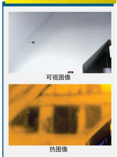
图 8-1.热检查报告通常包括热图像和相应的可视图像,以供参考。
