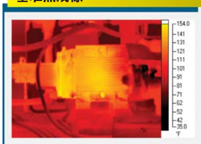
图 7-2.电机热图案中的许多差异将在后续热检查中显示出来。
