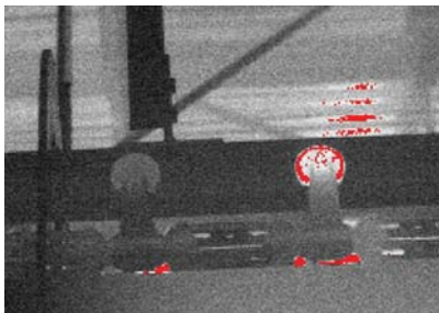
图 5-52. 高空电车的轴承温度过高会导致消耗过多电能,久而久之会导致锁链拉伸。
