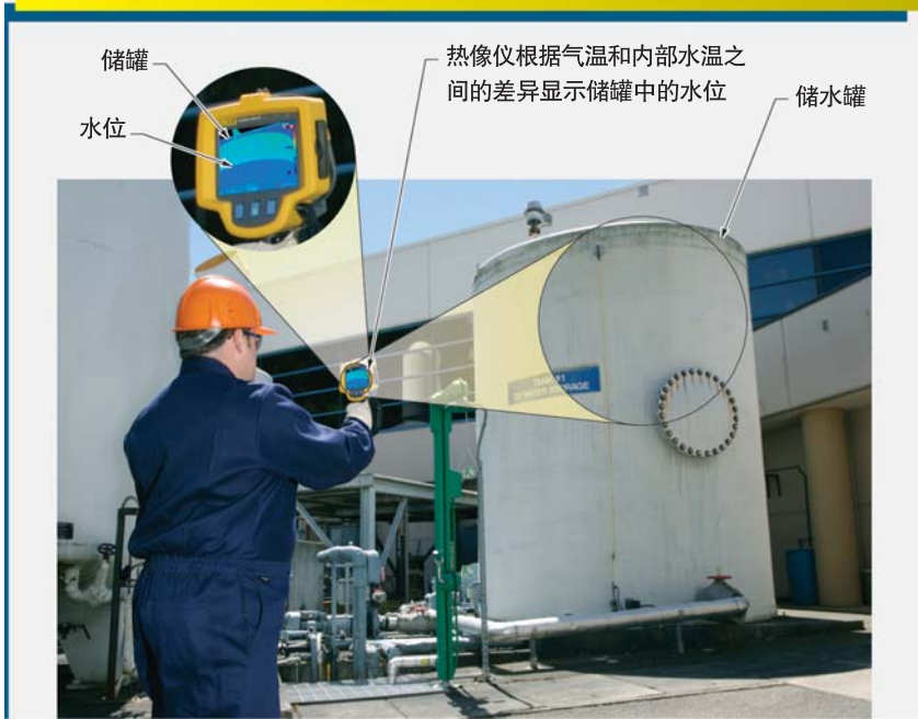
图 6-4.热成像技术最常见的应用之一是指出或确定容器(例如储罐和存储塔)中材料的填充水平。
