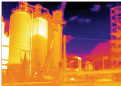
图 5-61. 在最佳条件下, 借助热像仪可以轻松看到存储罐的液位。
