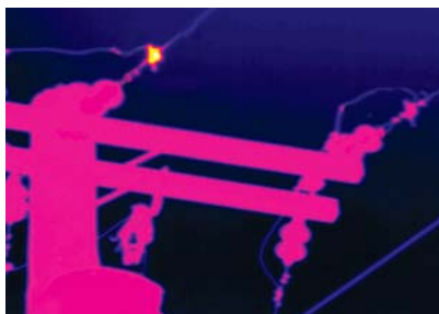
图 5-16. 如果负载进一步增加,则跳线上的高电阻连接(可能由于腐蚀)会造成严重的后果。
