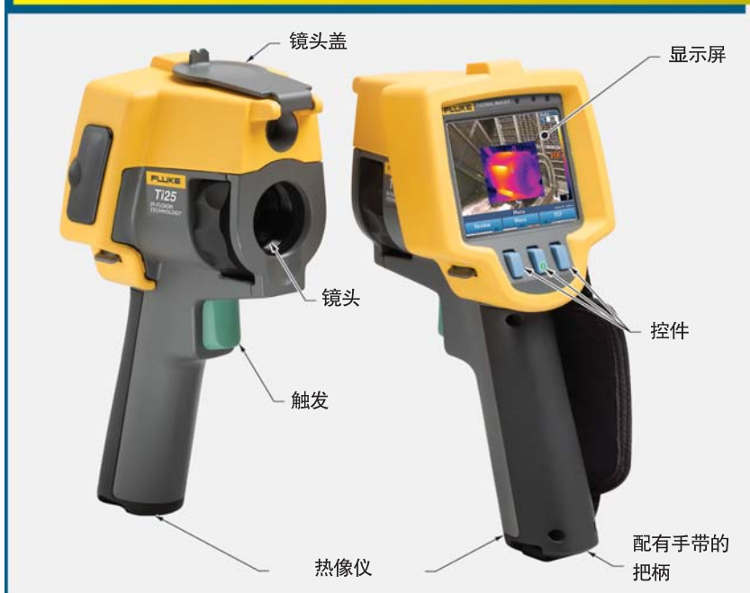
图 1-4. 典型的热像仪由多个常用组件组成, 包括镜头、镜头盖、显示屏、控件和配有手带的把柄。
