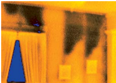
图 5-69. 现有壁腔中安装不当的松散保温材料可以解决问题，但未达到预期效果。
