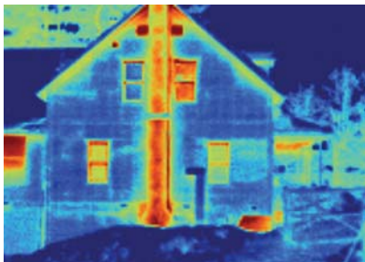
图 5-48. 建筑物外部视图的热图像可以清晰显示问题区域,例如缺失了保温材料的浅色区域。
