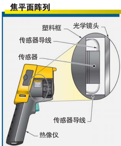
图 1-2. 焦平面阵列 (FPA) 是一种图像传感设备, 由位于镜头焦平面处的光传感像素阵列 (通常为矩形) 组成。
