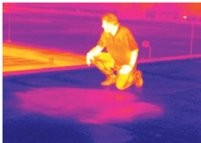
图 5-53. 在最适合拍摄热图像的傍晚,湿屋顶保温材料区域在屋顶上显示为温点。
