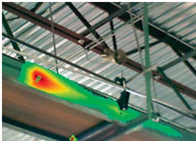
图 5-67. 皮带与高架输送机系统托盘摩擦会在热图案中产生热点。由于附近的滚筒轴承受到磨损，皮带发生了偏离。结果，不断增加的摩擦会导致驱动电机过热。
