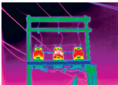
图 5-40. 一台变压器的操作温度高于高架台上其它变压器的温度可能是潜在问题的征兆。
