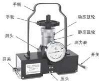
图6 磁力式硬度计
