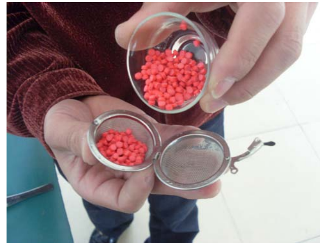
8、将颗粒倒入金属球中 (注意：在倒入时，不可将颗粒遗落)
