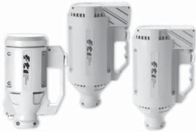
电机为单相110V或220V，50-60Hz。所有电机配备12feet（336cm）电源线，手动设定断路器，内置风扇和on-off开关。电机为持续负载型。
