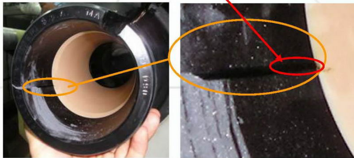
实验室加压测试证实其内部放电，解剖后发现划伤及放电痕迹。
