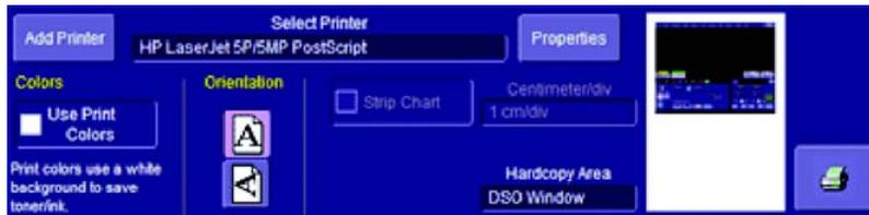
3. 如果想在白色背景上打印轨迹，在 **Colors** 下，触摸 **Use Print Colors** 复选框。白色背景可以节省打印机墨粉。(可以在 Preference 对话框中改变打印机颜色)
