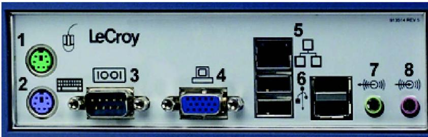
(1) 鼠标 \*; (2) 键盘; (3) RS-232-C 端口; (4) 外置 VGA 监视器; (5) 以太网端口;
