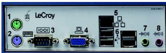
WaveRunner Xi 侧面板，包括远程控制使用的 LAN 端口 (5)
