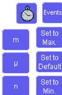
7. 触摸 **Holdoff** 栏，选择触发抑制，然后触摸 **Time** 或 **Events** 按钮。使用弹出数字键盘，输入一个值，指定时间单位，或使用向上/向下按钮，以 200 ps 增量提高或降低值。也可以触摸其中一个预置值按钮。
