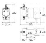
**B/C 系列: 手动/自动控制** 最大冲程频率 100spm 功率: 29W(B 系列), 44W/87W(C 系列)
