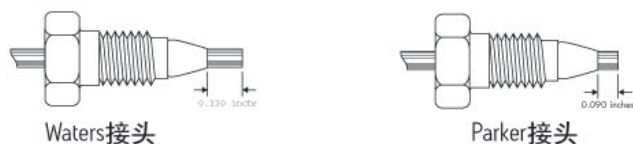
图2 管路与色谱柱正确连接的系统
