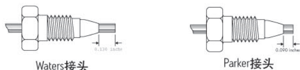
图2 管路与色谱柱正确连接的系统
