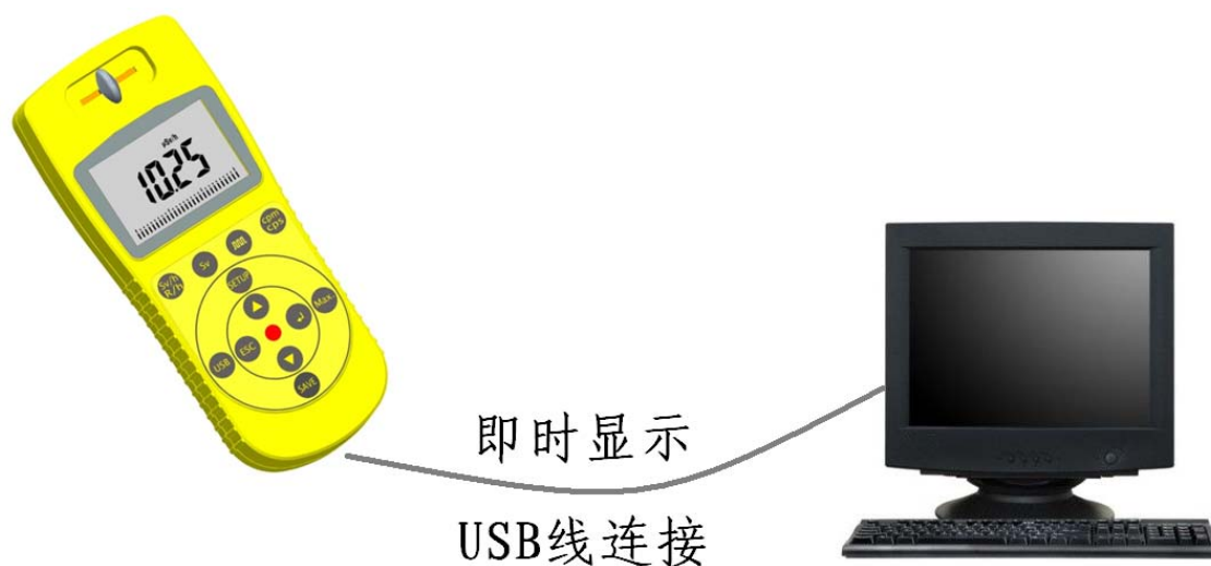
电脑和辐射仪连接示意图
