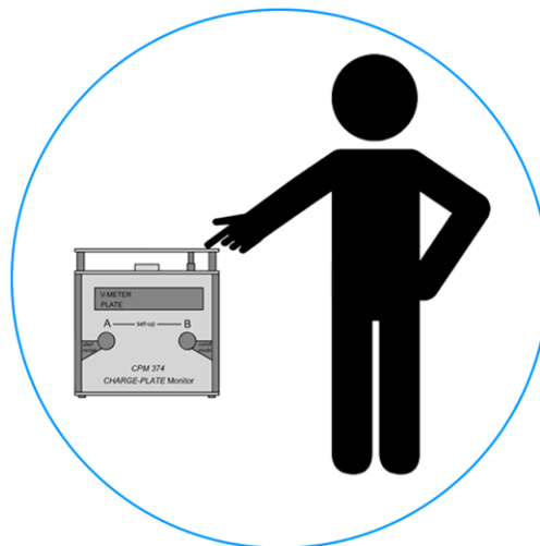
测试人体行走静电电压（方式一） 直接接触电极板
