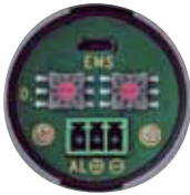
支持可同时供 电和模拟输出 的 2 线制回路
