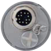
支持全面输入/ 输出功能的 12 针连接器
