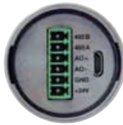
支持模拟输出 和 RS-485 通 讯的 6 针连接 器
