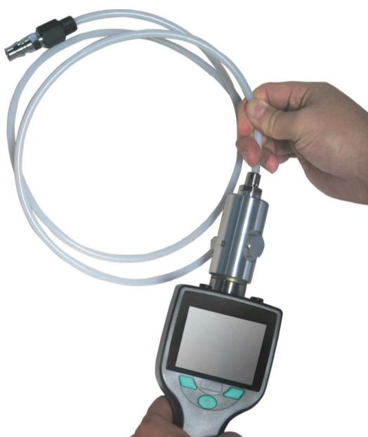
4. 将特氟龙软管与测量室连接一起。软管的一端连接在测量室 6mm 接口处。
