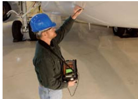
Phasor XS能进行翼上大面积彻底检测，包括对铝合金材料部件结构材料进行测试。
