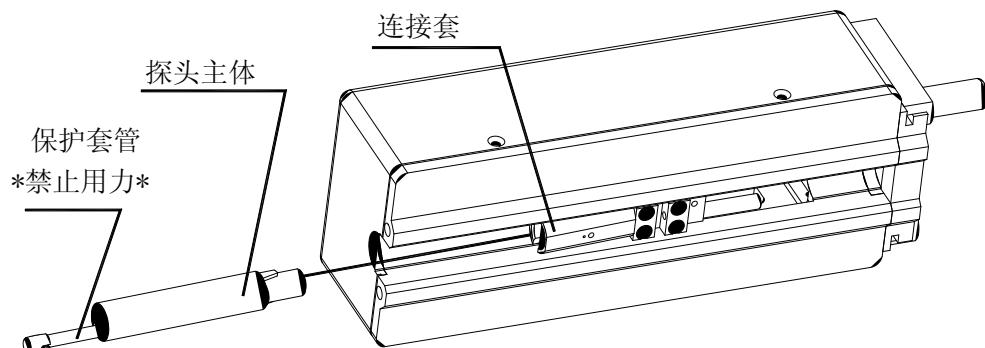
安装时，用手拿住**探头主体**部分，按图所示将探头插入仪器底部的传感器连接套中，然后，**ESC**轻推到底。拆卸时，用手拿住传感器的**探头主体**部分或保护套管的根部，慢慢地向外拉出。
