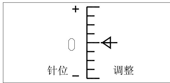
在主界面状态下，按 触针位置键用于切换触针位置显示界面和主显示界面。
