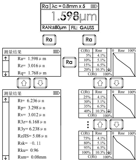
测量完毕后，可以通过如图按键方式观察全部测量结果
