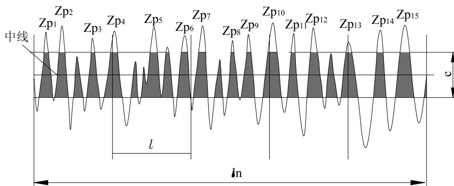
图中的 C 为两条以中线为中心对称并与中线平行的直线间的距离。C 值的选择有两种方式，一种是绝对值方式，即 C 值实际距离的绝对值；另一种是相对百分数方式选定。首先确定评定所需要的 C 值，然后，计算 RPc 峰计数值，一个高于 C 值的峰与一个相邻的低于 C 值的谷组成 RPc 峰计数值的一个数。RPc 是在评定长度上计算评定的，公式如下：
