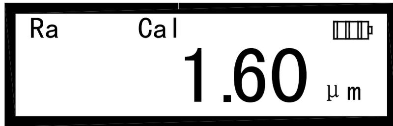
将仪器置于该样块刻线区上，传感器滑行方向垂直于刻线的纹理方向，按下启动键，开始一次校准测量。
