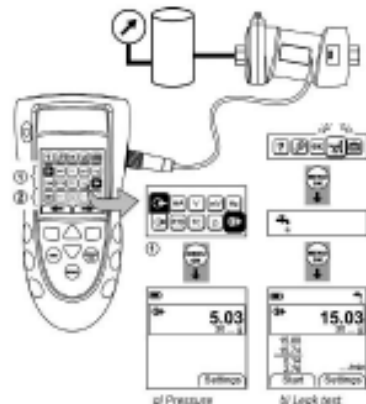
DPI880 外部智能压力模块压力及泄漏测试
