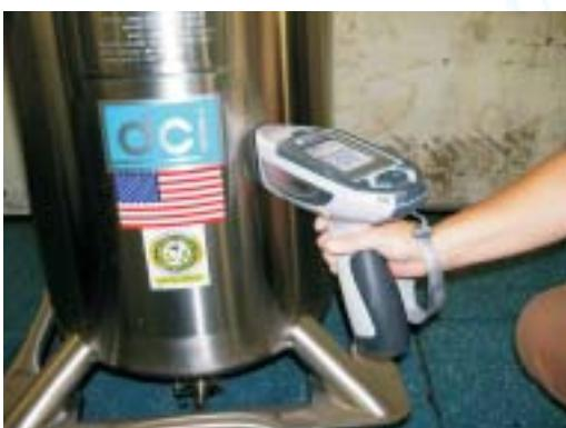
现在有了 NITON XL3t-800 这个在手持式 XRF 技术上取得巨大进步的分析仪，质量控制以及检测人员可以在完全无损的条件下，每天精准地检测上千个金属合金样品。事实上，即使是初级检验员也能很有把握地将大量的样品测出完整而精确的结果。
