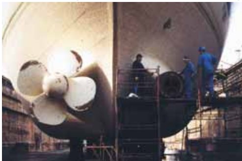
7 孔同心度 (变直径孔, 例如轮船螺旋桨尾轴孔)
