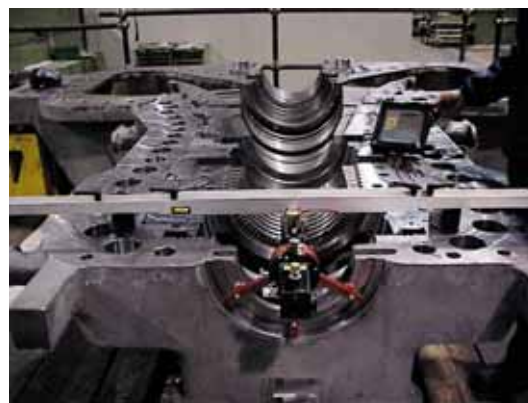
9 汽机隔板同心度测量
