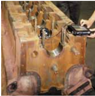
4 孔同心度 (同直径孔, 例如柴油机孔)
