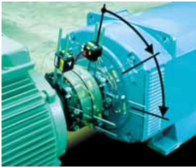
图 (2) 用“激光对中仪”找轴对中
