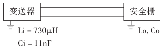
图 2.5 安全栅连接图
