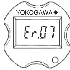
图 8.5.1 用内藏指示计检查故障
