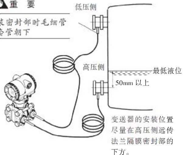
图 4.2 液罐安装实例
