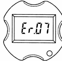
图 8.5.1 用内藏指示计检查故障
