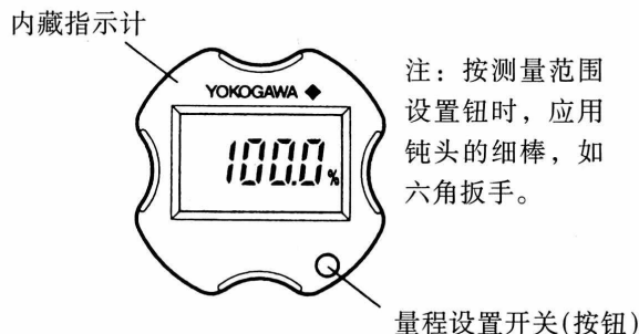
图 7.6 测量范围设置开关
