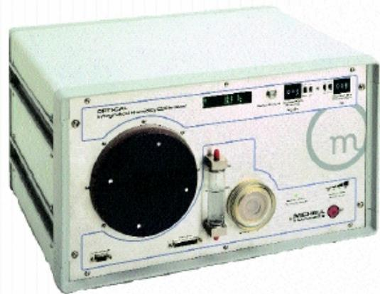
和潮湿饱和的混合气体。为取得最大稳定性和最小梯形温度，腔室温度由四区珀耳帖加热泵控制。从饱和器前部可以很容易地对其充注蒸馏水。而设计干燥器的通路时也充分考虑到便于在必要时刻再加热的操作。仪表无须其它保养。对外部系统唯一的要求是单相供电电源。
