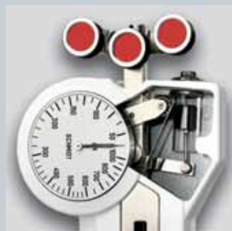
图1: 可调阻尼 (选型 A) 以提供稳定的 张力读数
