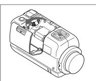
根据电池仓内的极性指示,装入4节5号电池。
