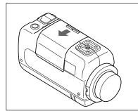
② 朝着箭头▼尖端方向向上推动,以滑动本 仪器侧面的电池仓盖,使其打开。
