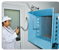
皮托管测试 压差及风速
